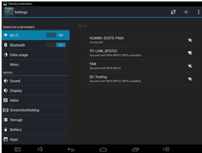
Choisir le réseau sans fil souhaité, le système se connectera directement au réseau ou ouvrira la fenêtre de mot de passe selon les paramètres de restriction d'accès du réseau. Consultez votre administrateur de réseau sans fil pour le mot de passe.
